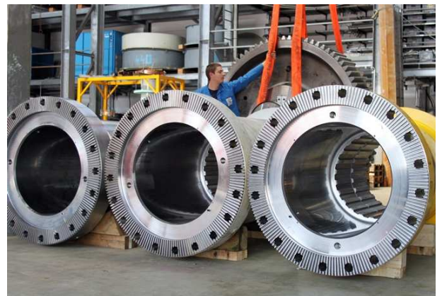
Abb.2: Zahnhülsen mit Bronze-Innenbeschichtung
