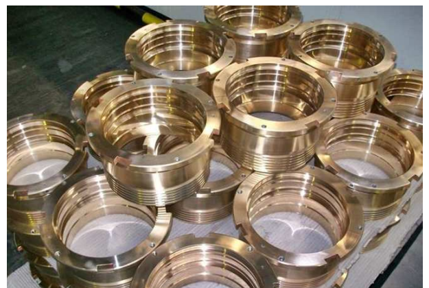
Abb.3: Komplettbeschichtete Gewindebuchsen (40 µm)
