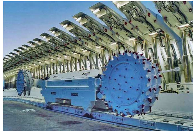
Abb.1: Grubenstempel mit 60 µm Bronze-Beschichtung
