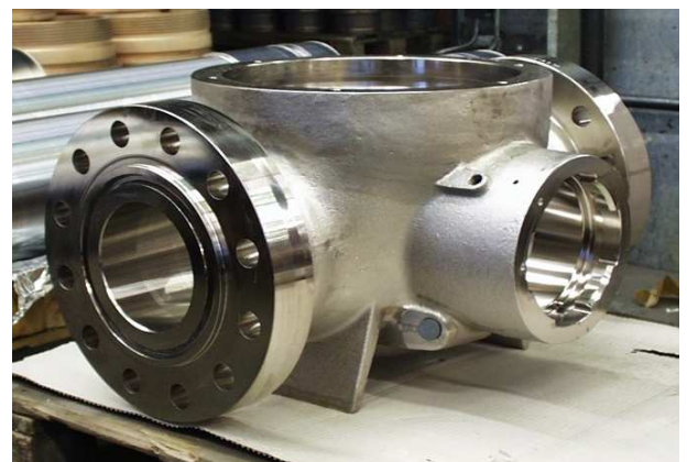
Abb.3: Offshore-Kugelkükken mit 75 μm NiP ↑
