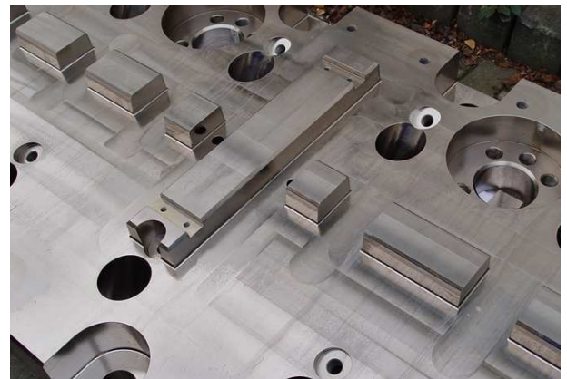
Abb.2: Trägerplatte mit 30 μm Chemisch Nickel
