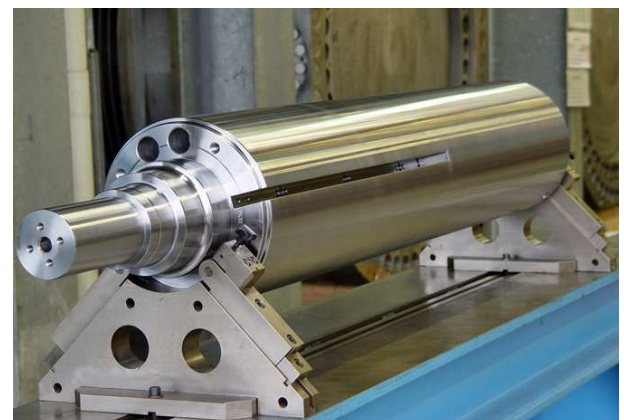
Abb.3: Druckzylinder mit 120 µm Hart-Chrom
