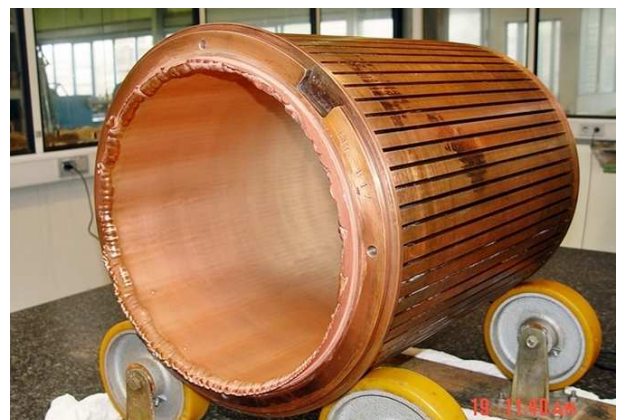
Abb.3: Rohrkokille mit 3.000 µm Kupfer-Beschichtung
