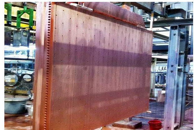
Abb.2: Trägerplatte (3,9 t) für Quetten-Härtepressen
