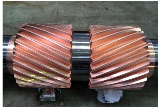
Abb.1: Kammwalze (6,8 t) mit verkupferten Zahnrädern
