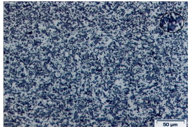
Abb.4: Homogene, agglomeratfreie Partikelverteilung
