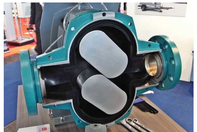
Abb.3: Mit 60 µm NICABOR® beschichtete Drehkolben
