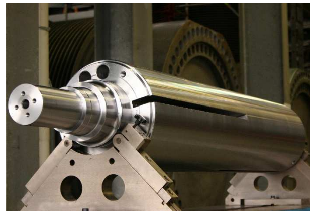
Abb.2: Druckzylinder mit 200 µm NICABOR®
