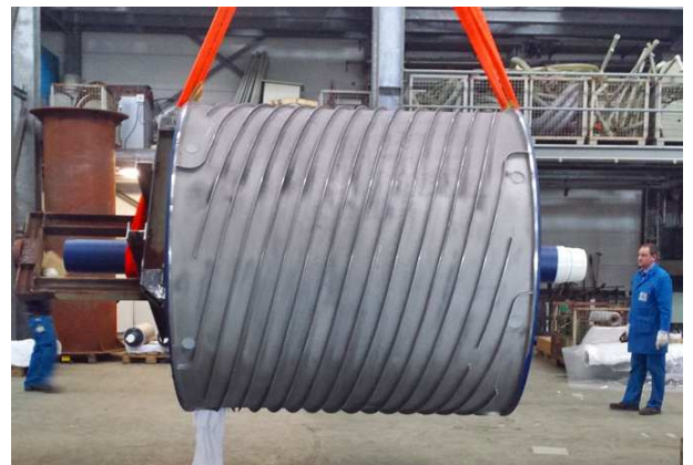
Abb.2: Beschichtung von Gießwalzen (bis \varnothing 3.200 \text{ mm} )
