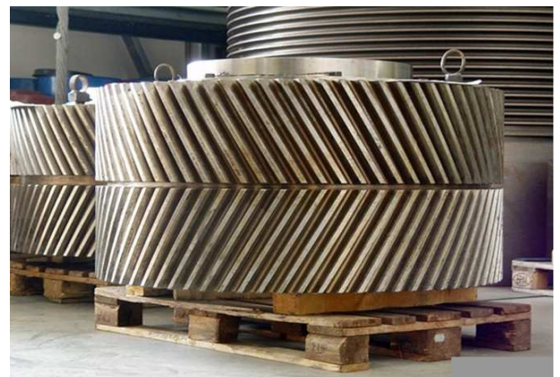
Abb.4: Reparaturbeschichtung einer Zahnradnabe (4 t)
