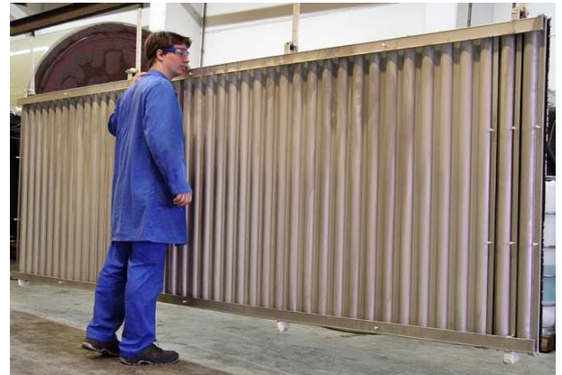
Abb.3: Nickel-Sulfamat beschichtete Panelwand
