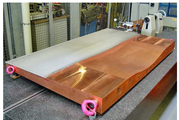
Abb.5: Kokille mit einer 5.000 µm Beschichtung
