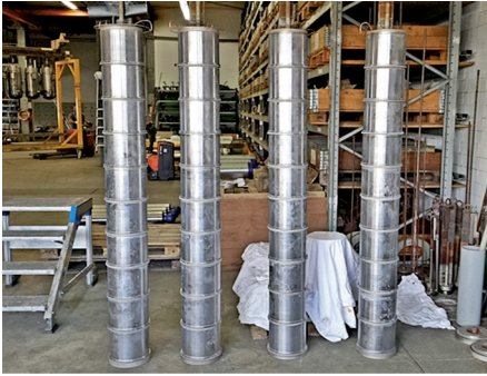
Abb. 3: Elektrolytisch vernickelte Galletten vor der Spritzbeschichtung
